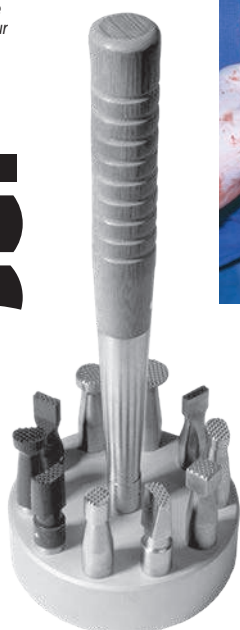
Tailles de l'impacteur en delrin
